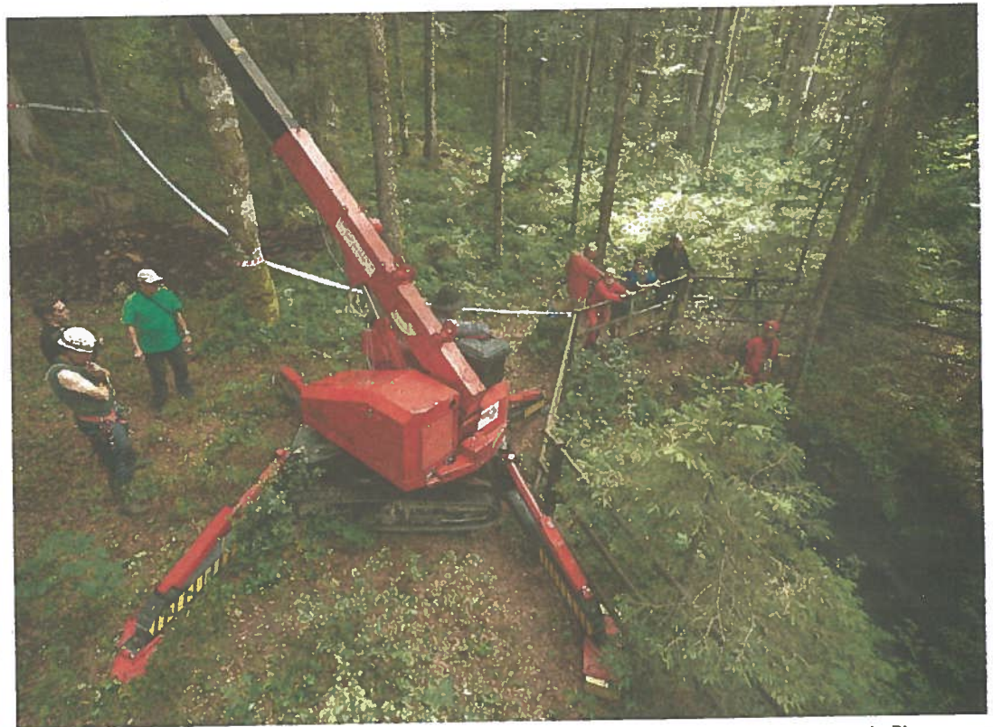
Une grue est utilisée pour ressortir les gravats accumulés au fil des siècles au fond de la Baume du Risoux.
